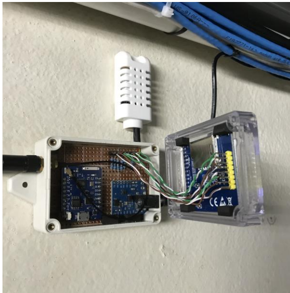
รูปที่ 12 วงจรการเชื่อมต่อบอร์ด WemosD1R2 จะเชื่อมต่อ Relay เพื่อควบคุมการทำงาน
